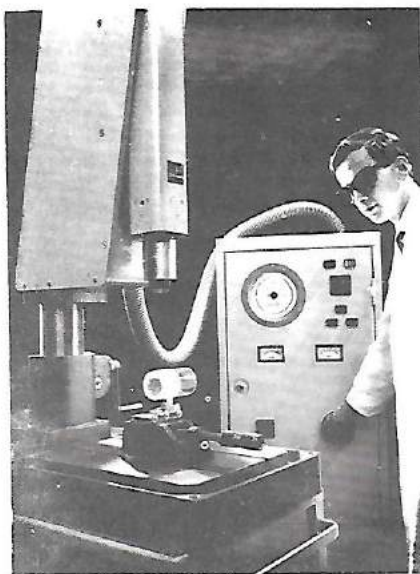
LASER AU GAZ CARBONIQUE PERMETTANT LA SOUDURE DU VERRE
